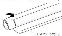
3. カールホルダーの端をめくり上げ、モスクリーンカールに被せながら折り曲げます。
